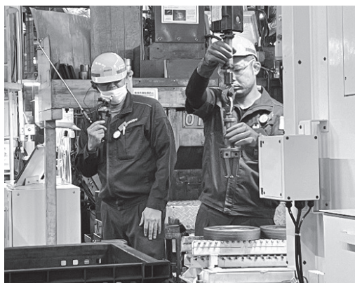
重量物対策クレーン
